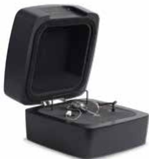
Caisson de test TBS10 pour aides auditives, compatible avec Callisto
