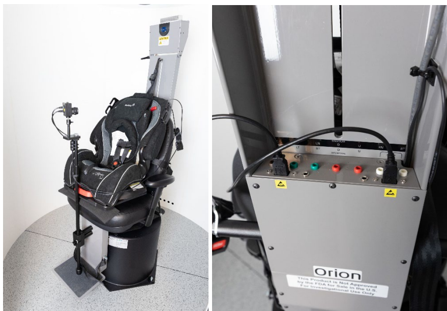
2.6-29. attēls: Pediatrijas novērošanas kamera, kas piestiprināta pie Orion Auto-Traversal/Comprehensive krēsla un savienota ar USB porti krēsla aizmugurē
