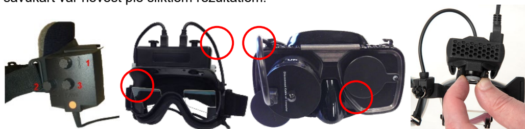
3.6-2. attēls: Dažādu VNG un vHIT brīļu fokusa regulēšana
