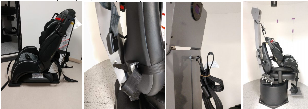
2.6-28. attēls: Secīgi zīdaiņu autokrēsliņa uzstādīšanas attēli uz Auto-Traversal/Comprehensive krēsla (no kreisās uz labo)
