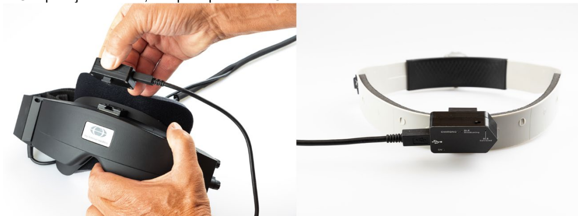
2.6-17. attēls: VORTEQ™ IMU ir uzstādīts uz sānu stiprinājuma brillēm (pa kreisi) un uz galvas lentes dinamiskam redzes asuma noteikšanai (pa labi)
