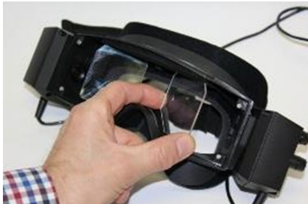
2.6-4. attēls: Regulējami infrasarkanie spoguļi starpzīlīšu attāluma regulēšanai (pa kreisi) un slēdži 1) kameras vertikālai regulēšanai, 2) kameras horizontālai regulēšanai, 3) kameras fokusa regulēšanai (pa labi)
