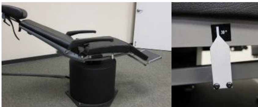
3.9. attēls-3 Noliekts krēsls kaloriskajai testēšanai ar kaloriskā leņķa marķieri
