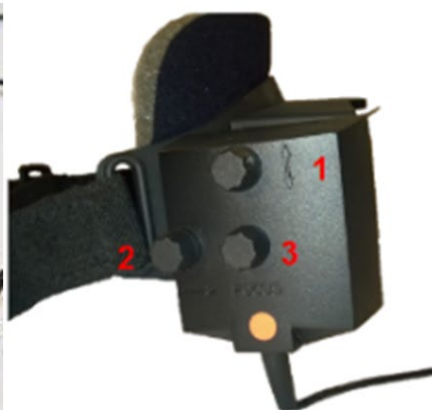
2.6-4. attēls: Regulējami infrasarkanie spoguļi starpzīlīšu attāluma regulēšanai (pa kreisi) un slēdži 1) kameras vertikālai regulēšanai, 2) kameras horizontālai regulēšanai, 3) kameras fokusa regulēšanai (pa labi)
