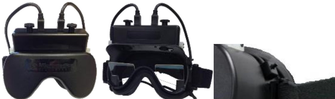
Afbeelding 3.6.5 Bril met camera aan bovenzijde. Plaat komt voor op de bril te liggen voor testen waarbij het zicht is geblokkeerd. De schakelaar aan de linkerkant van de bril start en stopt de test
