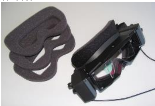
Figur 3.5.4 Utskiftbare skumputer for sidemonteret-briller
