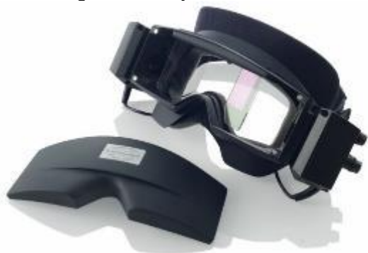
Figur 3.6.3 Sidemontert kamera brille
