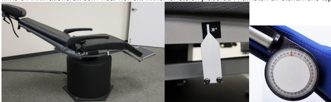
Figur 4.4. 3 Fällbar stol för kalarisk testning med kalarisk vinkelmarkering och inklinationsratt
