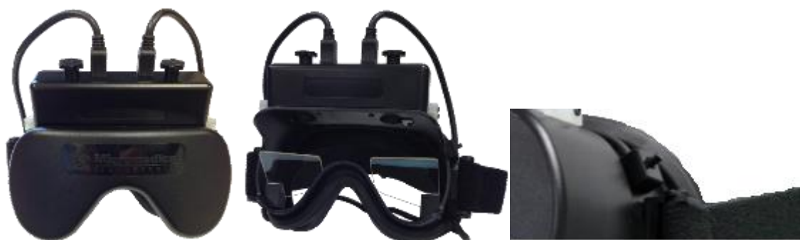
Figur 3. 6. 5 Glasögon med toppmonterad kamera. Överdraget placeras över glasögonen för tester utan syn. Strömbrytaren på glasögonens vänstra sida startar och stoppar testet
