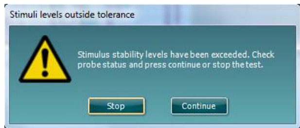
Abbildung 4 – Sondentest fehlgeschlagen/fehlerhafte Sonde
