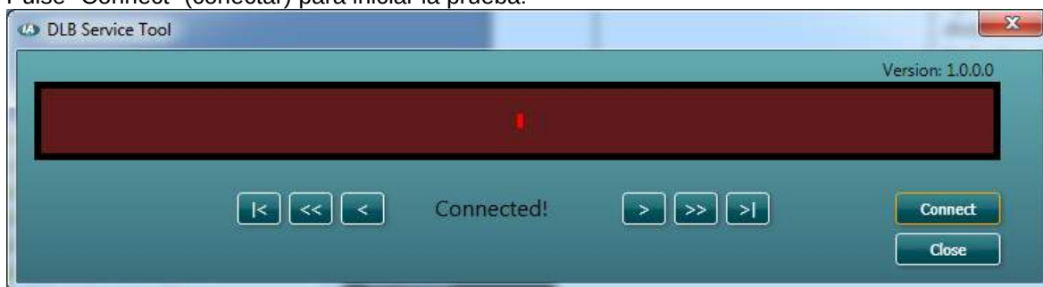
Imagen 2.9 Comprobación de funcionalidad de los diodos de la barra de iluminación digital
